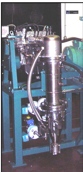
SISTEMA DE EVAPORACIÓN Y LIMPIEZA DE GLICERINA
