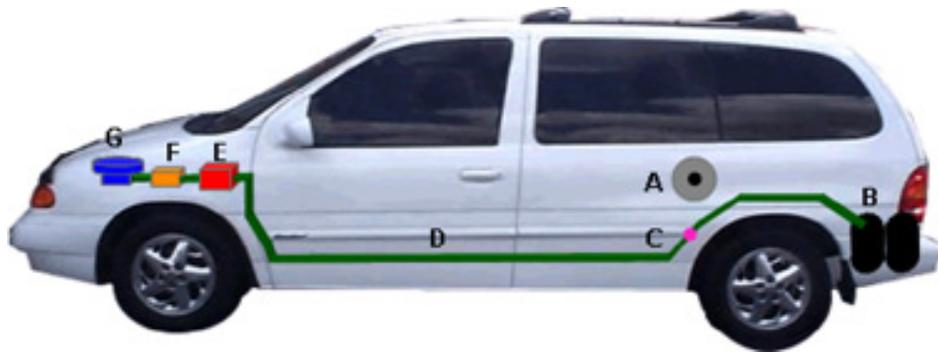
*Figura 1. Equipamiento adicional de un vehículo de gas natural.*
