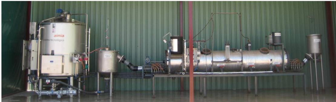
*Figura 3. Planta piloto de demostración de la codigestión de cultivos y deyecciones ganaderas. UBIMET-C3000.*
