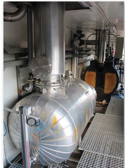
Área de regeneración de la amina. La columna horizontal es la torre de destilación de la amina.
