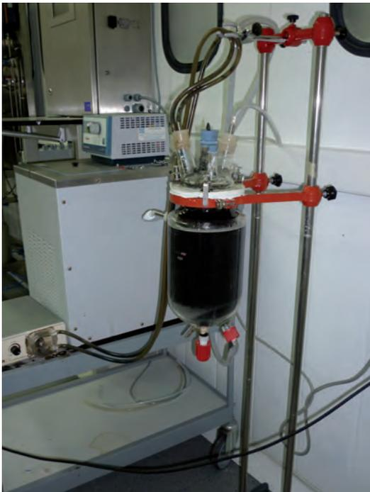
Figura 5. Imagen montaje experimental para adaptación biomasa fase termófila.
