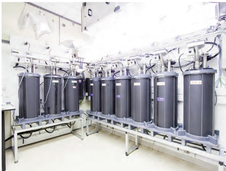
Figura 2. Arriba la planta piloto de digestión anaerobia convencional en semicontinuo y a la izquierda la planta piloto DA2T.
